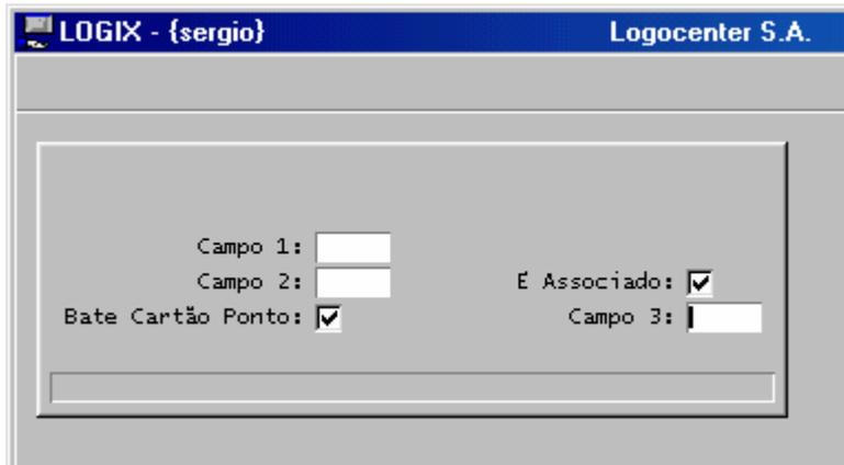
A opção **config** possui 3 parâmetros. Os dois primeiros parâmetros são respectivamente os valores retornados pelo “checkbox” (S – Sim e N – Não) quando marcado e desmarcado. O terceiro parâmetro é o nome do campo a ser exibido do lado direito do “checkbox”. Este parâmetro não deverá conter nada entre os caracteres “{}”.
