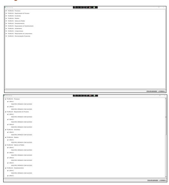
A tela de log exibe uma árvore com detalhes de cada registro durante a operação de importação, indicando se a operação foi bem-sucedida ou se ocorreu algum erro específico.
